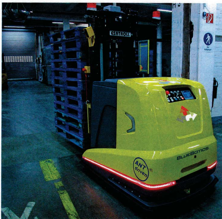
Le robot de manutention de palettes Esatroll se dirige grâce au système de navigation ANT.
