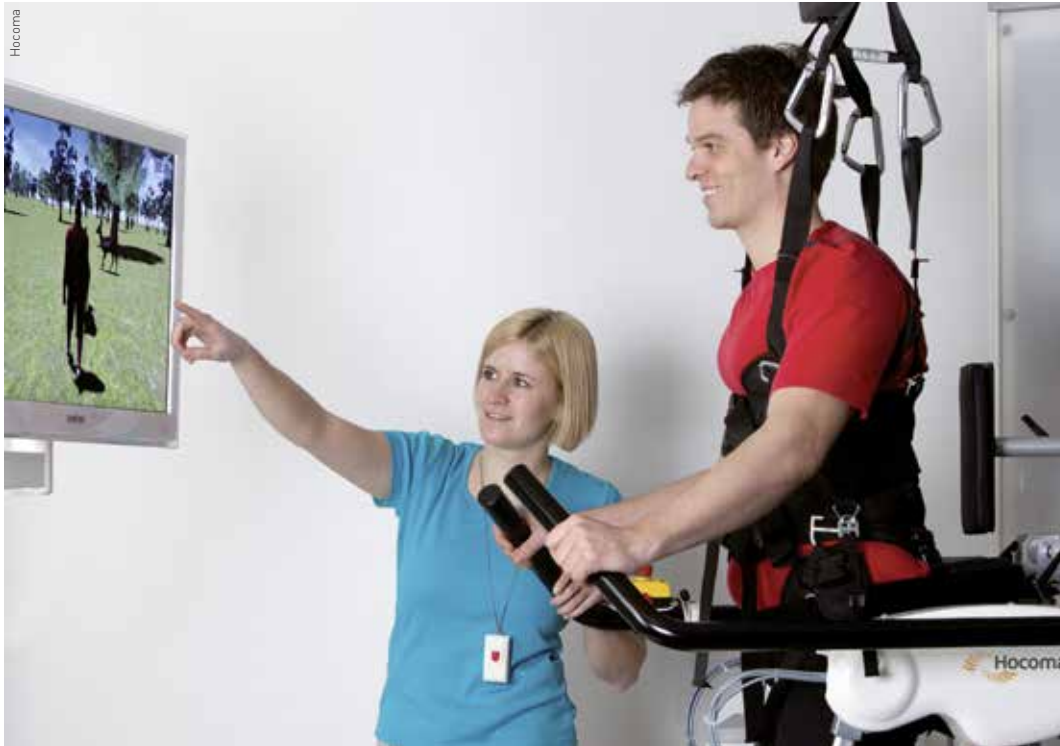
Die robotergestützte Gangorthese Lokomat automatisiert die Lokomotionstherapie auf einem Laufband und steigert die Effizienz des Laufbandtrainings.
