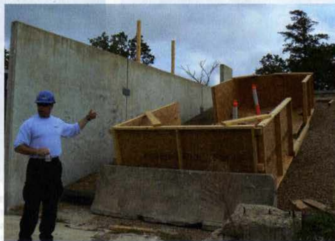
Adam Jacoff erläutert die Testarenen für die Response Robot Evaluation Exercise. In dieser Arena müssen die Roboter auf unebenem Untergrund und in Schräglage in möglichst kurzer Zeit zehnmal einen achtförmigen Kurs um die beiden rotweißen Säulen fahren.
