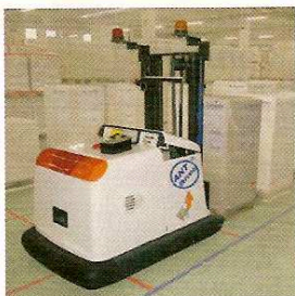
Paquito ist mit der autonomen Navigationstechnologie ANT ausgerüstet, hat eine Nutzlast von 1200 kg und handhabt bis zu 2,2 m hohe Paletten.
